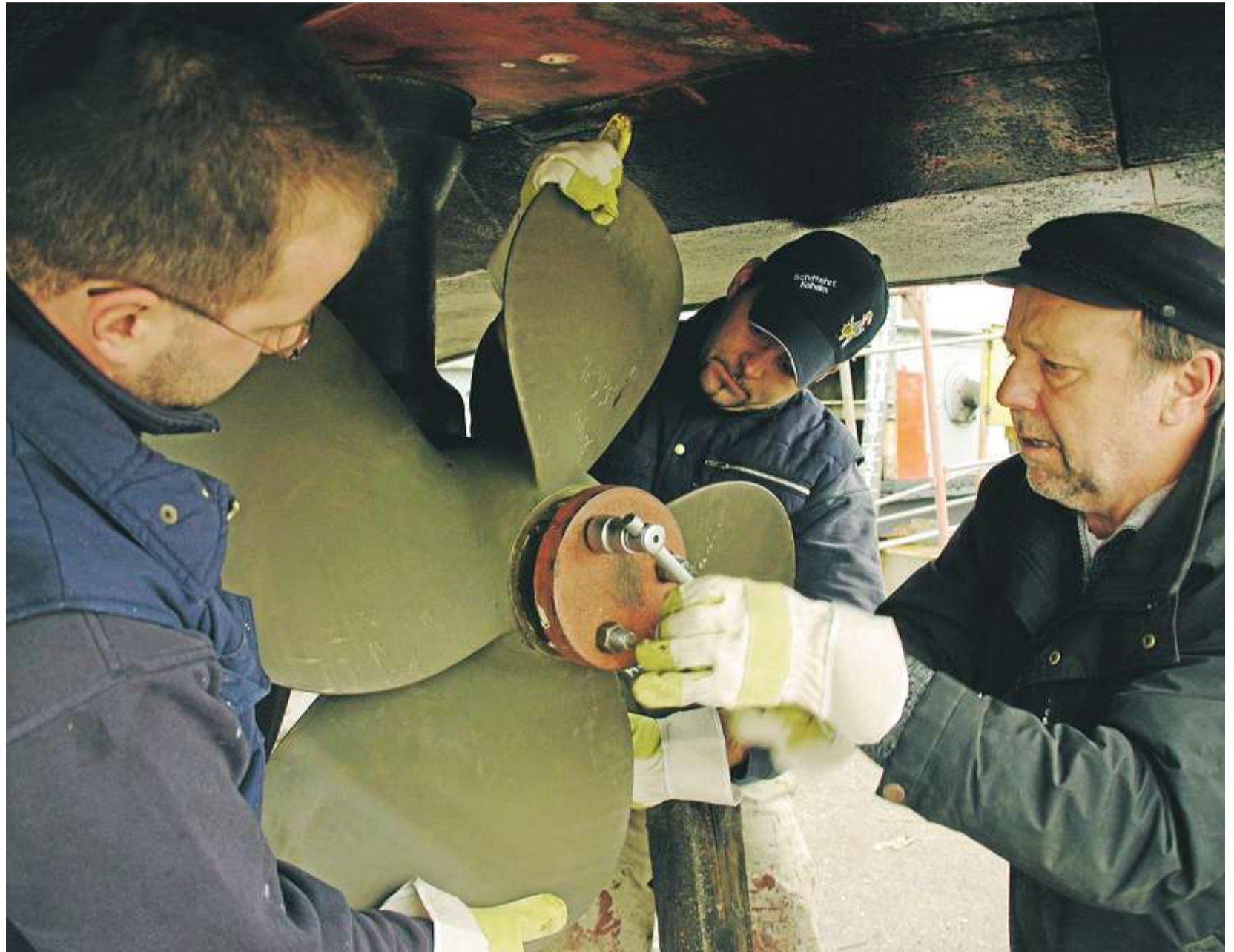
Mit vereinten Kräften montiert die Mannschaft die 100 Kilo schweren Schiffsschrauben ab.
